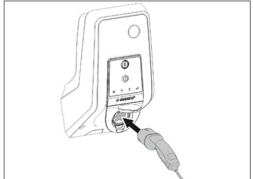
Afb.: 9. Laadkabel aansluiten
