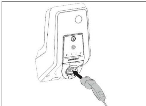
9. ábra: A töltőkábel csatlakoztatása
